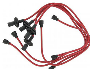
Bougiekabel set high performance 7 mm (koperen kern) rood type-1 motoren t/m 9.1992
