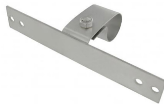
Steun nationaliteits plaatje RVS Kever t/m 7.1967 USA modellen, Karmann Ghia t/m 7.1971 USA modellen, Bus t/m 7.1967 USA modellen
