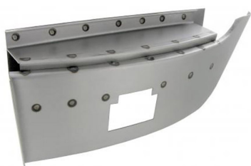
Instaphoek onderzijde links Bus t/m 7.1967
