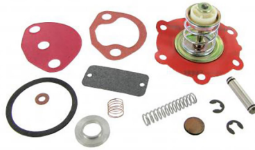
Benzinepomp revisieset type-1 motor 1200cc (34pk) t/m 7.1965, type-3 motor t/m 7.1965
