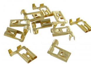
Ongeïsoleerde haakse vrouwelijke vlakstekkers met weerhaak (10 stuks) Spade connectormaat: 8.0mm, Materiaal dikte: 0.8mm, Draad dikte: 1.5- 2.5mm 2
