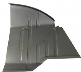
Vloerplaat reparatiedeel cabine rechts Bus t/m 7.1967
