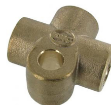
Remleiding T-stuk Schroefdraadmaat: M10 X 1.0, Montagegat: 7mm, Lengte: 30mm, Breedte: 30mm
