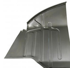
Vloerplaat reparatiedeel cabine links Bus 4.1955 t/m 7.1967
